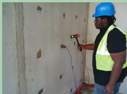
Figure n°2 : Maillage des points d'essais sur voile béton
