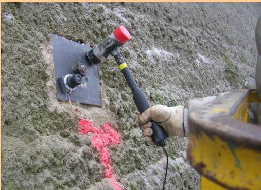
Figure n°2 : instrumentation plaque d'appui
